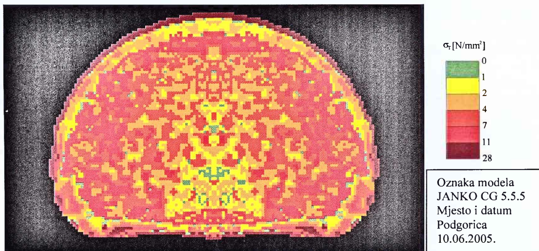
Slika 5.37 Raspodjela napona na granici plastične deformacije u poprečnom presjeku pršljena rukovaoca dizalice
