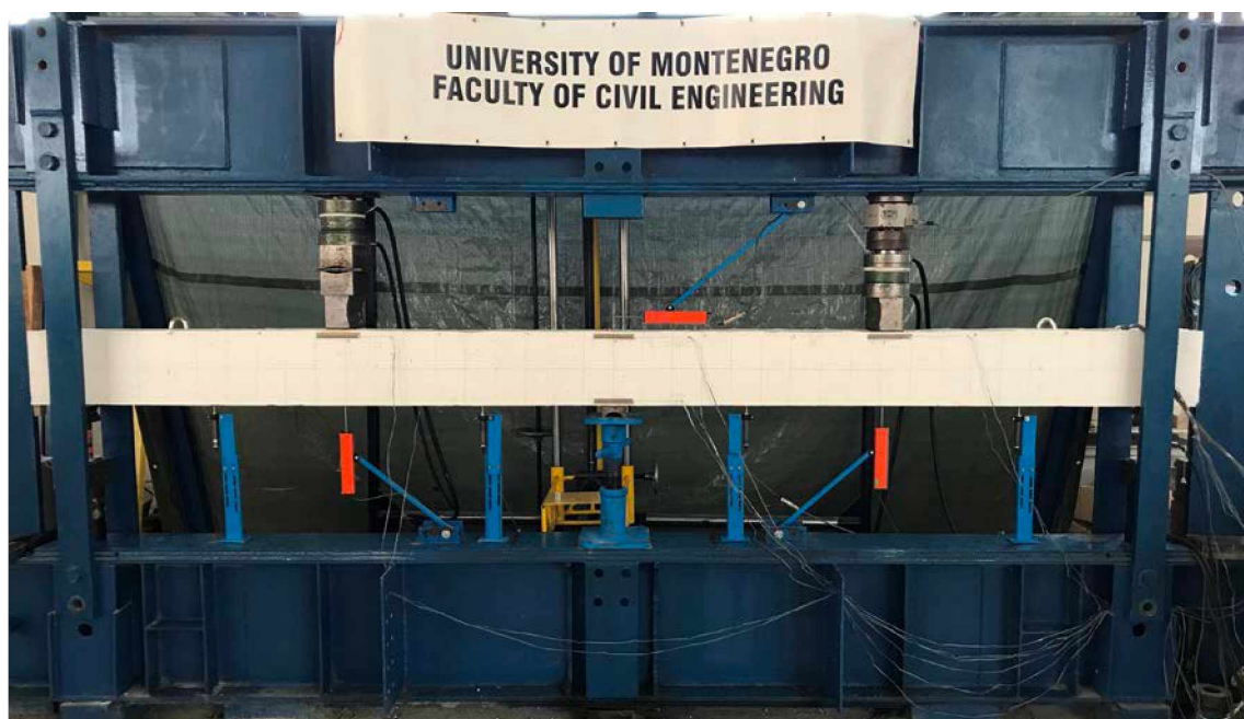
Slika 3.13 – Opremljena kontinualna greda neposredno prije ispitivanja
