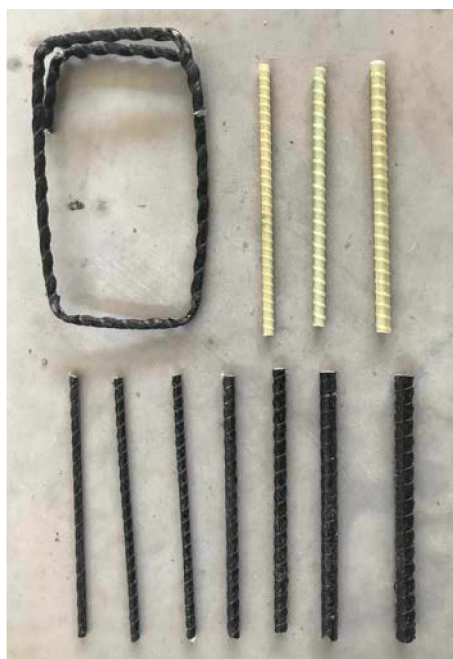
Slika 3.3 – GFRP podužna i poprečna armatura
