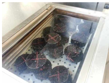
Slika 5.9 Kondicioniranje Maršalovih uzoraka u vodi na temperaturi od 40°C
