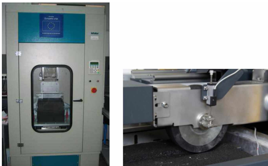
Slika 3.10 Segmentni nabijač i oprema za opit kolotražnja
