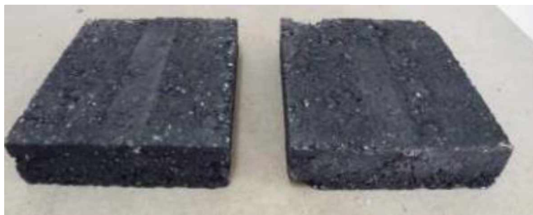
Slika 5.14 Izgled ploča poslije opita kolotražnja
