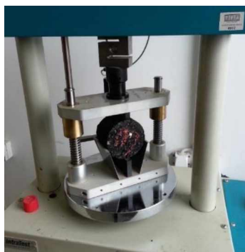
Slika 5.10 Položaj uzorka prilikom ispitivanja čvrstoće na indirektno zatezanje (ITS)
