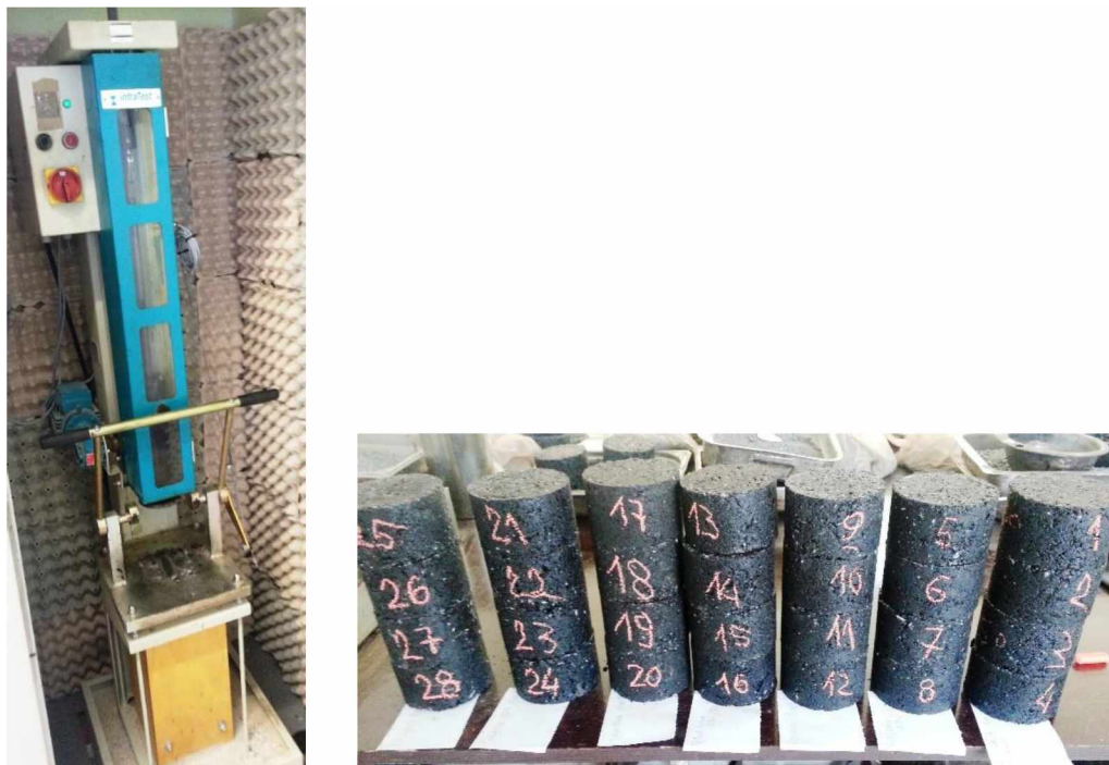
Slika 3.9 Maršalov nabijač i Maršalovi uzorci
