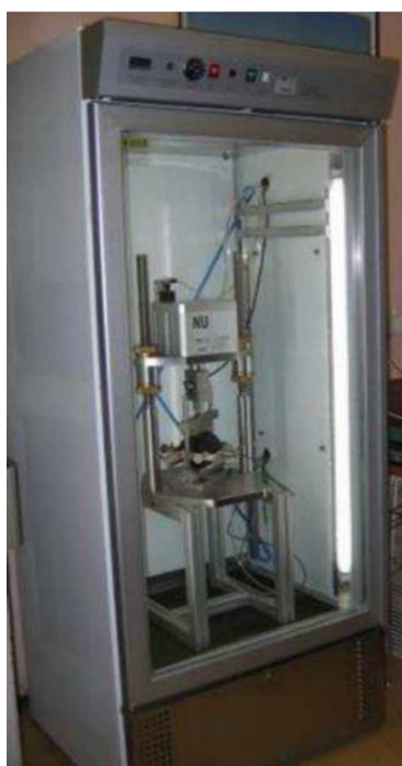
Slika 5.21 Ispitivanje modula krutosti
