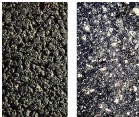
Slika 2.15 Asfaltni uzorak bez oštećenja (lijevo) i sa oštećenjem usled dejstva vode (desno)
