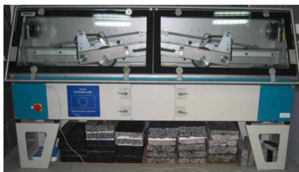
Slika 5.12 Uređaj za ispitivanje otpornosti na trajnu deformaciju
