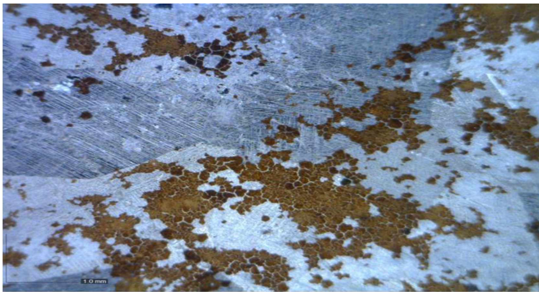
Slika 4.91. Površina kupona od cinka sa slojem korozionih produkata modificovanih smješom inhibitora T+B+P snimana pod povećanjem od 60 \times .
