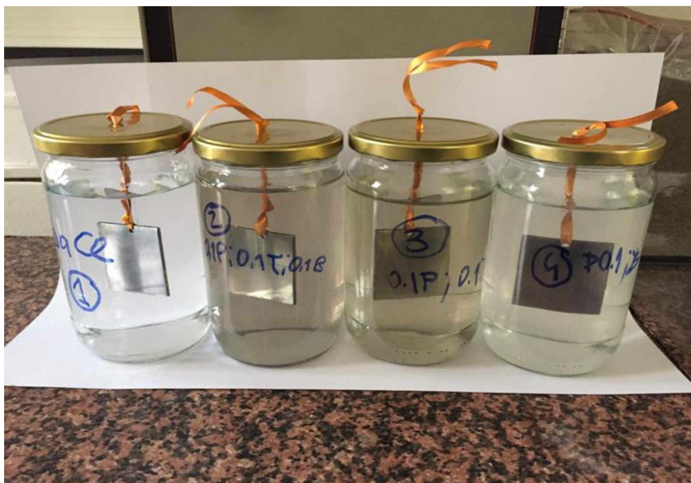
Slika 3.6. Izgled eksperimentalnog režima za FTIR, XRD i ICP-MS mjerenja.
