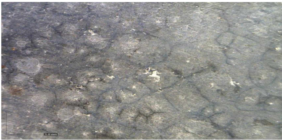
Slika 4.97. Površina kupona od pokalajisanog čeličnog lima sa slojem korozionih produkata modifikovanih smješom inhibitora T+B+P snimana pod povećanjem od 60 \times .
