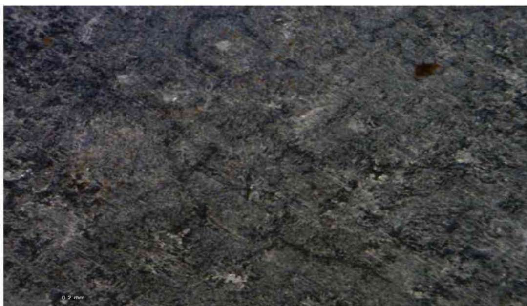
Slika 4.96. Površina kupona od pokalajisanog čeličnog lima sa slojem korozivnih produkata snimana pod povećanjem od 60 \times s polarizacionim filterom.
