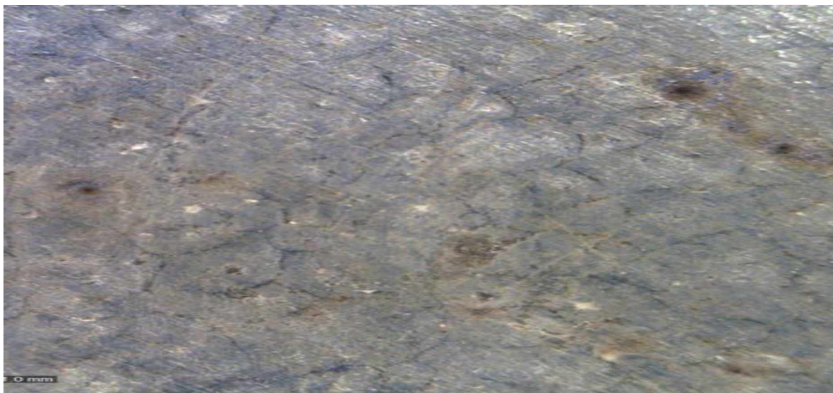
Slika 4.99. Površina kupona od pokalajisanog čeličnog lima sa slojem korozivnih produkata modifikovanih smješom inhibitora T+B+P+PEG+S snimana pod povećanjem od 60 \times .
