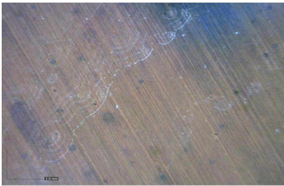
Slika 4.78. Površina kupona od bakra sa slojem korozionih produkata snimana pod povećanjem od 60 \times s polarizacionim filterom.
