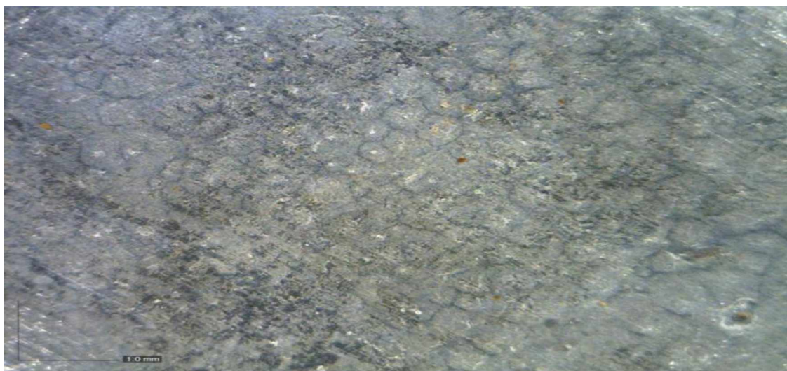
Slika 4.95. Površina kupona od pokalajisanog čeličnog lima sa slojem korozivnih produkata snimana pod povećanjem od 60 \times .
