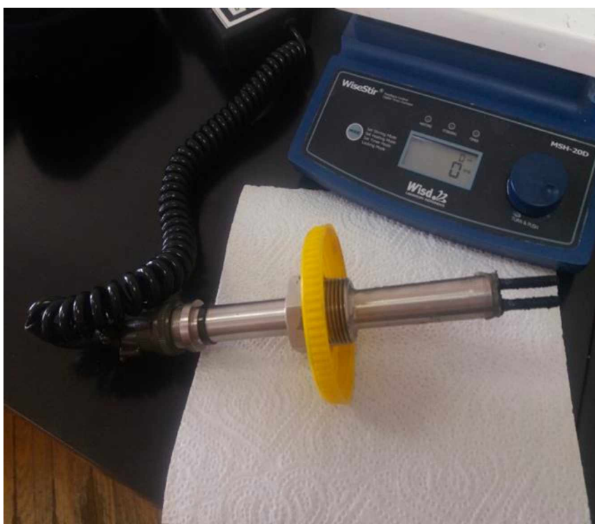
Slika 4.7. Izgled pinova LPR probe sa slojem inhibitorom modifikovanog sloja rđe.
