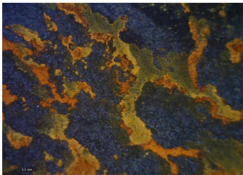
Slika 4.72. Površina kupona od čelika sa slojem korozionih produkata snimana pod povećanjem od 60\times s polarizacionim filterom.
