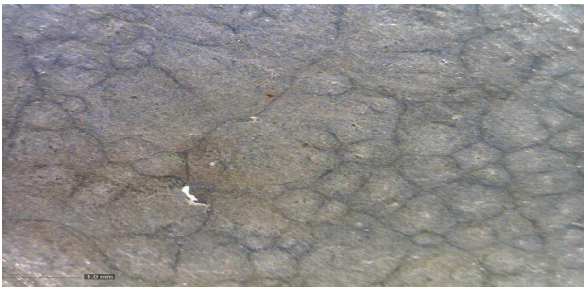
Slika 4.100. Površina kupona od pokalajisanog čeličnog lima nakon izlaganja rastvoru smješe inhibitora T+B+P+PEG+S snimana pod povećanjem od 60 \times .
