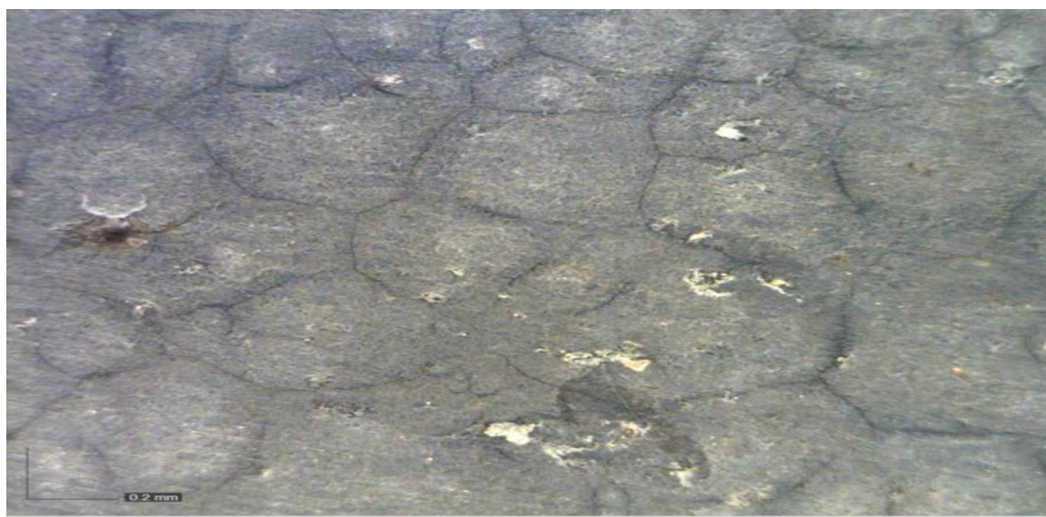
Slika 4.98. Površina kupona od pokalajisanog čeličnog lima sa slojem korozionih produkata modifikovanih smješom inhibitora T+B+P snimana pod povećanjem od 60 \times s polarizacionim filterom.
