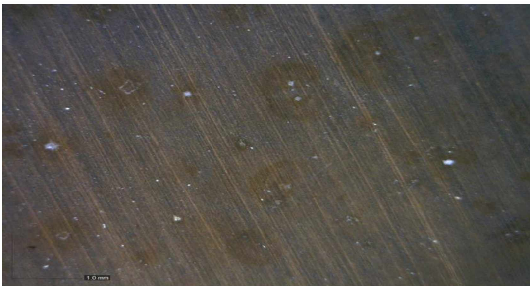
Slika 4.81. Površina kupona od bakra sa slojem korozionih produkata modifikovanih smješom inhibitora T+B+P+PEG+S snimana pod povećanjem od 60 \times .
