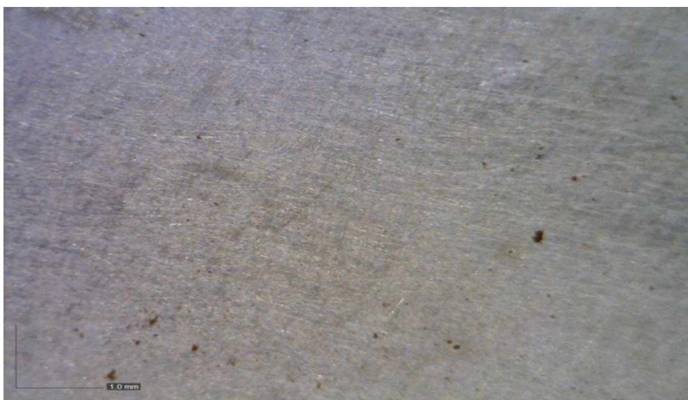
Slika 4.84. Površina kupona od aluminijuma sa slojem korozionih produkata snimana pod povećanjem od 60 \times s polarizacionim filterom.
