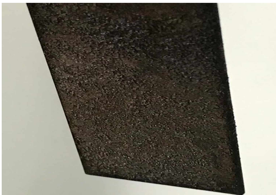
Slika 4.52. Kupon sa slojem, formiranim pod uticajem smješe inhibitora T+B+P+PEG+S.
