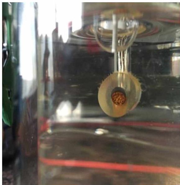
Slika 3.3. Izgled: a) troelektrodnog sistema za mjerenje impedanse i linearne polarizacije, b) izgled elektrode u sistemu bez inhibitora.
