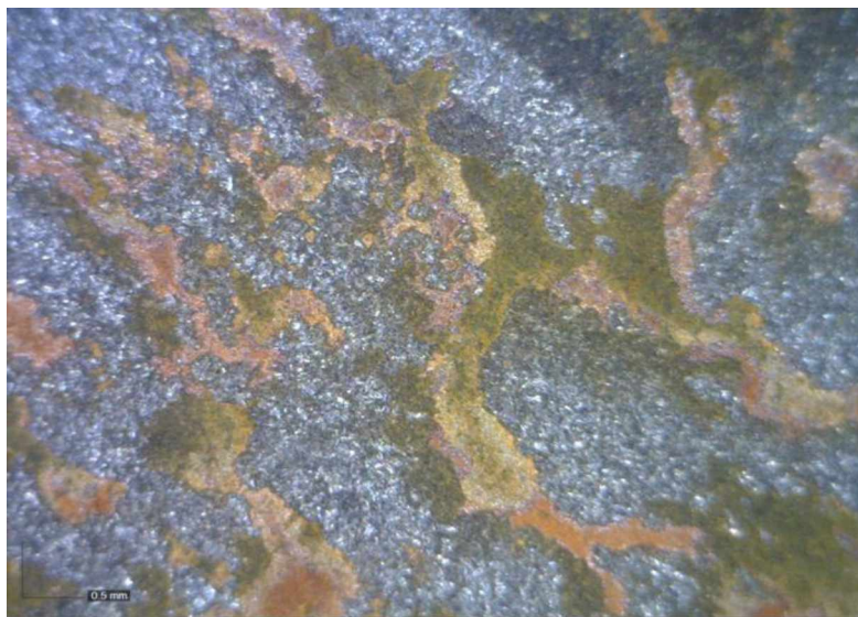
Slika 4.71. Površina kupona od čelika sa slojem korozionih produkata snimana pod povećanjem od 60\times .
