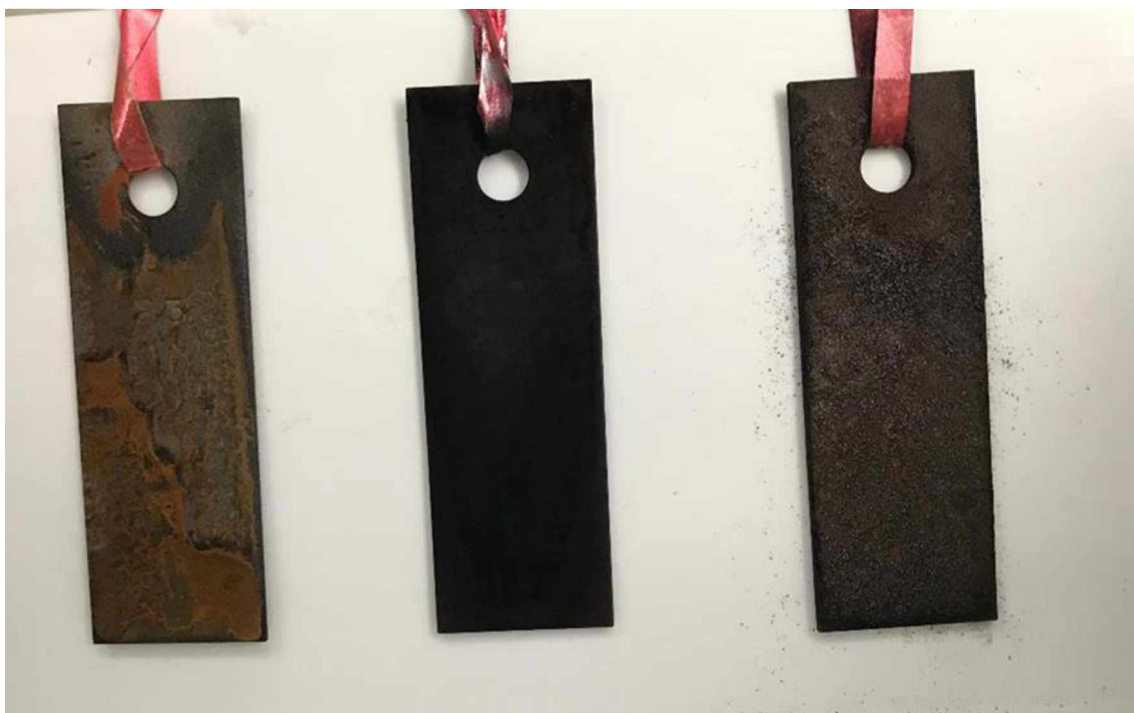
Slika 4.50. S lijeva na desno, kupon sa slojem rđe, kupon sa slojem, formiranim pod uticajem smješe inhibitora T+B+P i kupon sa slojem, formiranim pod uticajem smješe inhibitora T+B+P+PEG+S, respektivno.
