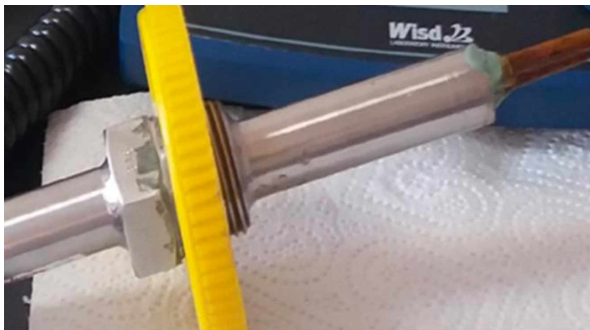
Slika 4.6. Izgled pinova LPR probe sa slojem čiste rđe.
