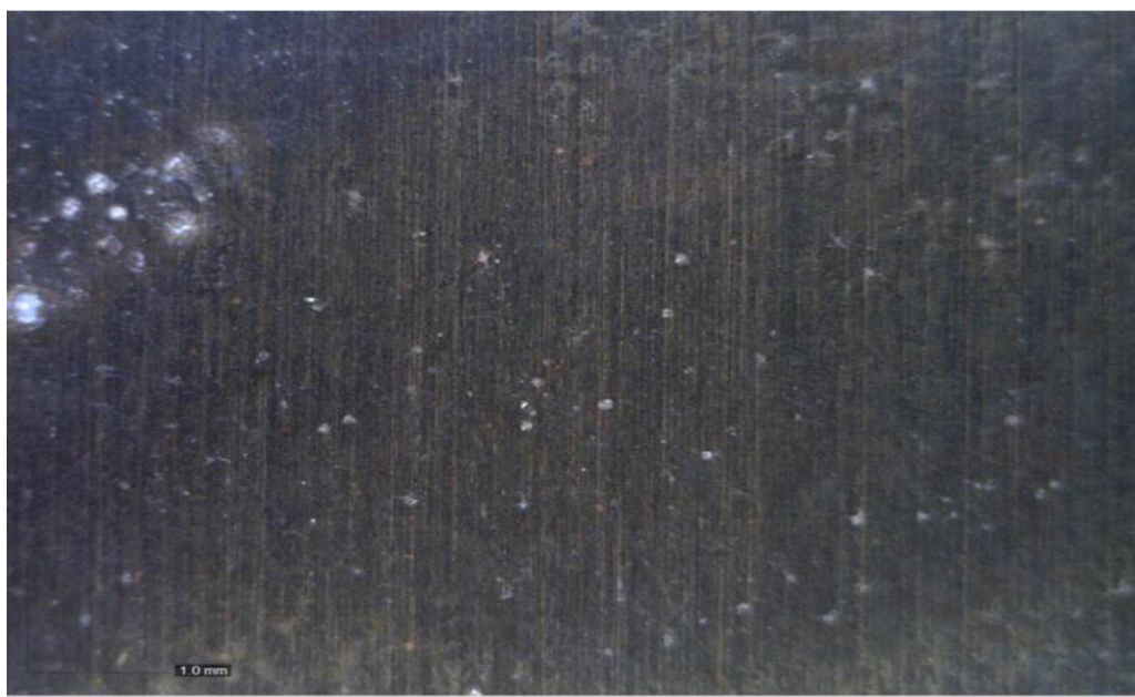
Slika 4.80. Površina kupona od bakra sa slojem korozionih produkata modifikovanih smješom inhibitora T+B+P snimana pod povećanjem od 60\times s polarizacionim filterom.
