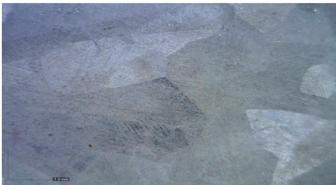
Slika 4.94. Površina kupona od cinka nakon izlaganja rastvoru smješe inhibitora T+B+P+PEG+S snimana pod povećanjem od 60 \times .
