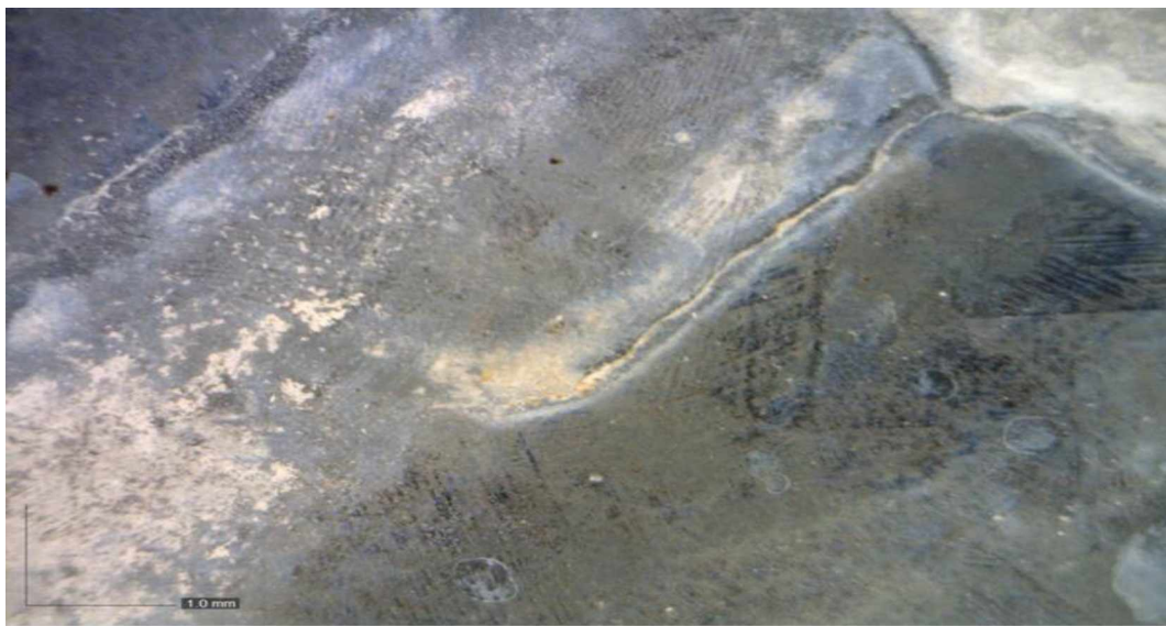
Slika 4.89. Površina kupona od cinka sa slojem korozivnih produkata snimana pod povećanjem od 60 \times .
