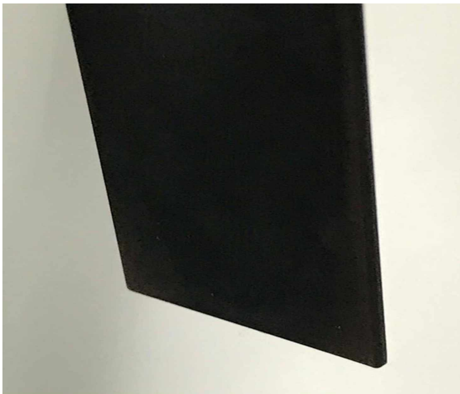
Slika 4.51. Kupon sa slojem, formiranim pod uticajem smješe inhibitora T+B+P.
