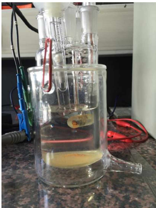
Slika 3.3. Izgled: a) troelektrodnog sistema za mjerenje impedanse i linearne polarizacije, b) izgled elektrode u sistemu bez inhibitora.
