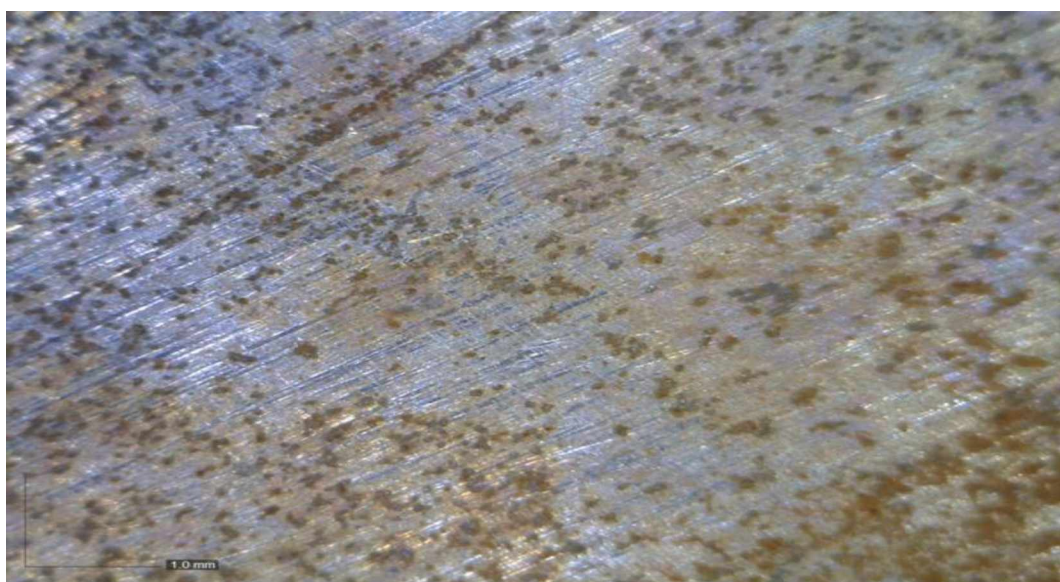
Slika 4.88. Površina kupona od aluminijuma sa slojem korozionih produkata modifikovanih smjesom inhibitora T+B+P+PEG+S snimana pod povećanjem od 60 \times s polarizacionim filterom.
