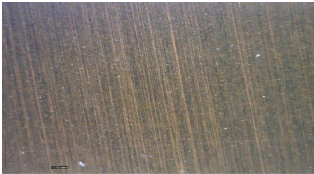
Slika 4.79. Površina kupona od bakra sa slojem korozionih produkata modifikovanih smješom inhibitora T+B+P snimana pod povećanjem od 60\times .
