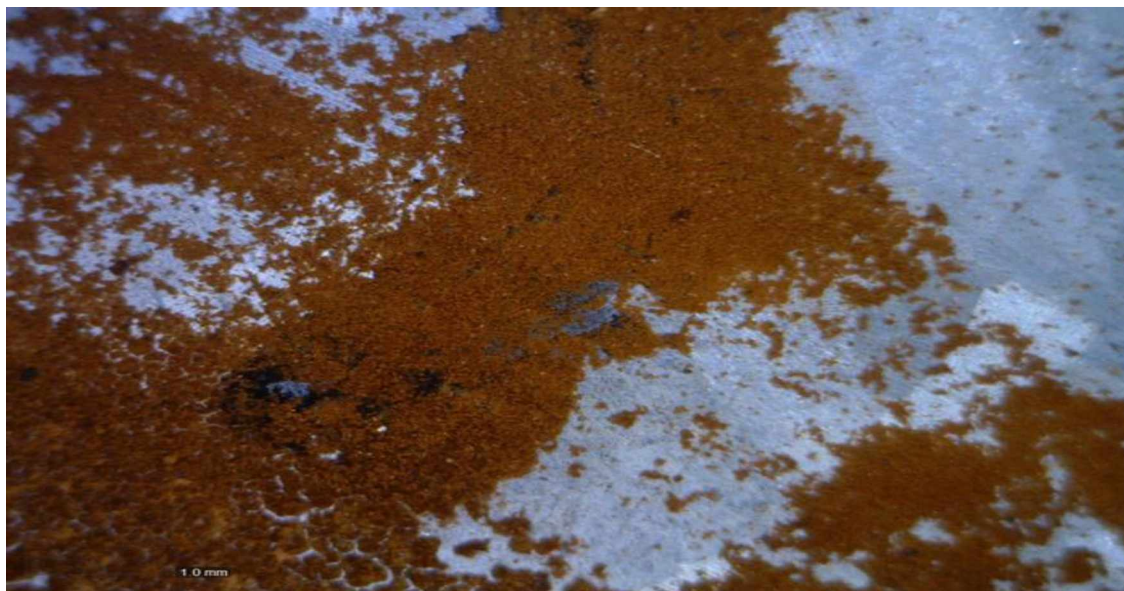
Slika 4.93. Površina kupona od cinka sa slojem korozionih produkata modifikovanih smješom inhibitora T+B+P+PEG+S snimana pod povećanjem od 60 \times .
