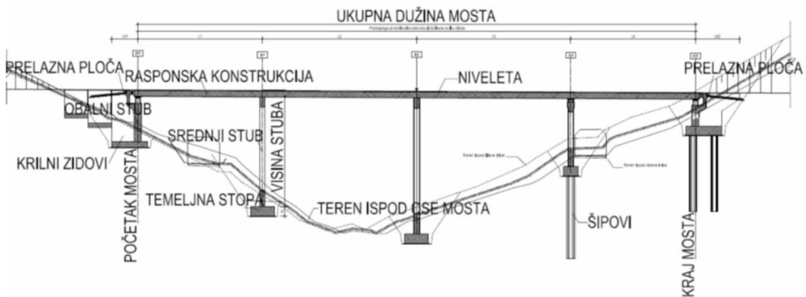
Slika 4.14 Nazivi djelova mosta u njegovoj konstrukciji (Kovačević, 2018)
