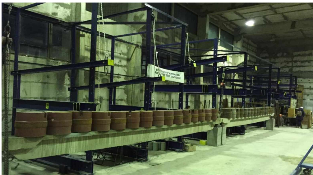
Slika 4.16 Ispitivanje grede pod dejstvom ravnomjernog opterećenja
