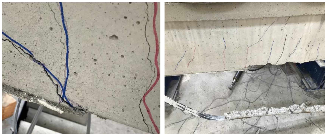
Slika 6.7 KDP kao uzročnik loma i odvajanje CFRP trake grede G9
