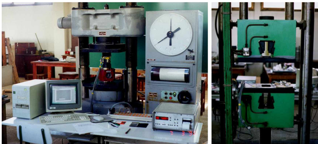
Slika 4.13 Laboratorijska oprema: a) hidraulična presa; b) kidalica
