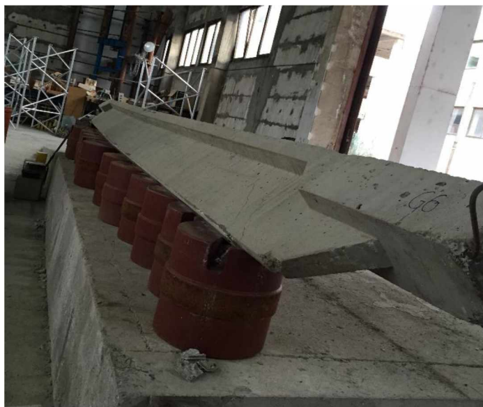
Slika 4.12 Demontirani uzorak nakon loma
