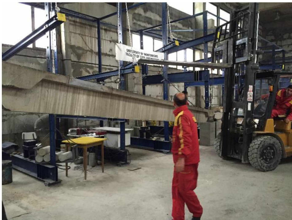
Slika 4.11 Postavljanje na oslonce ojačanih armirano-betonskih greda za ispitivanje
