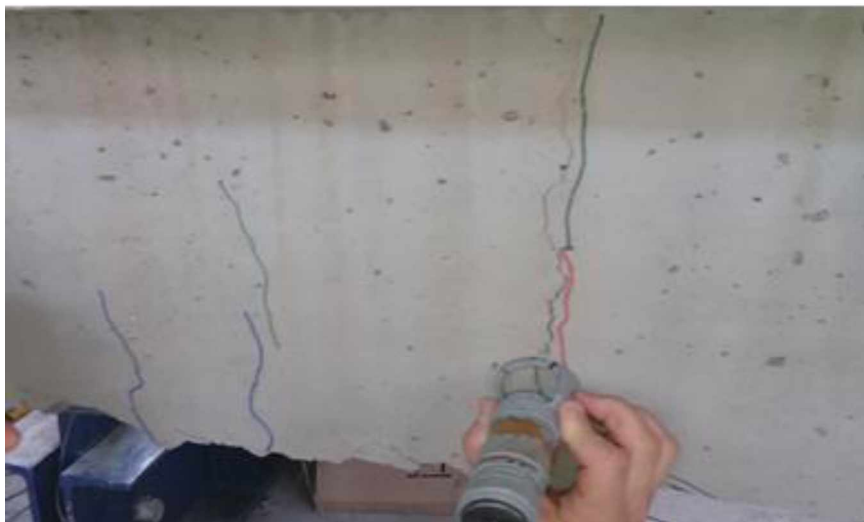
Slika 4.20 Mjerenje širine prslina
