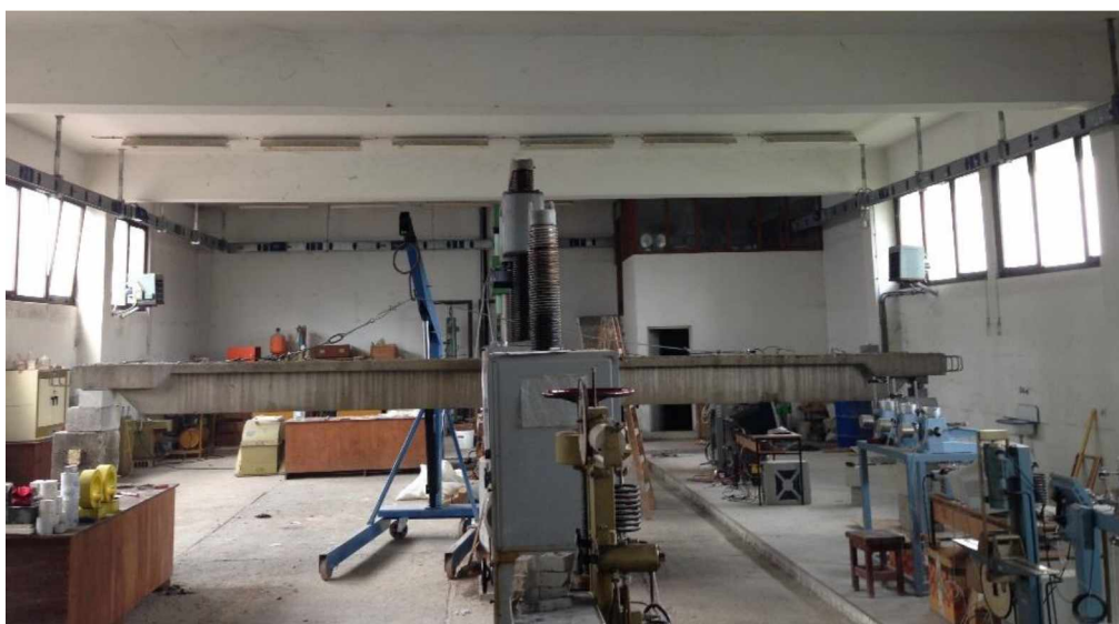
Slika 4.15 Ispitivanje greda opterećenih koncentrisanom silom
