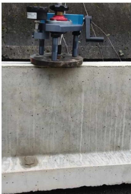
Slika 4.8 Aparatura za izvođenje testa i izgled uzorka nakon loma
