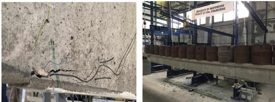
Slika 5.6 KDP kao uzročnik loma i izgled grede nakon loma
