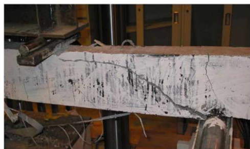
Slika 3.3 Mehanizam loma grede bez gubitka veze betona i FRP ojačanja [40]:
