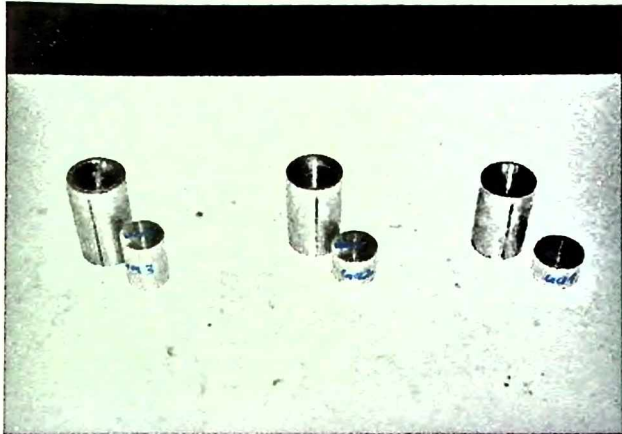
Slika P.6.7. Alati za stezanje segmentnih priprema pri obradi na konačnu mjeru
