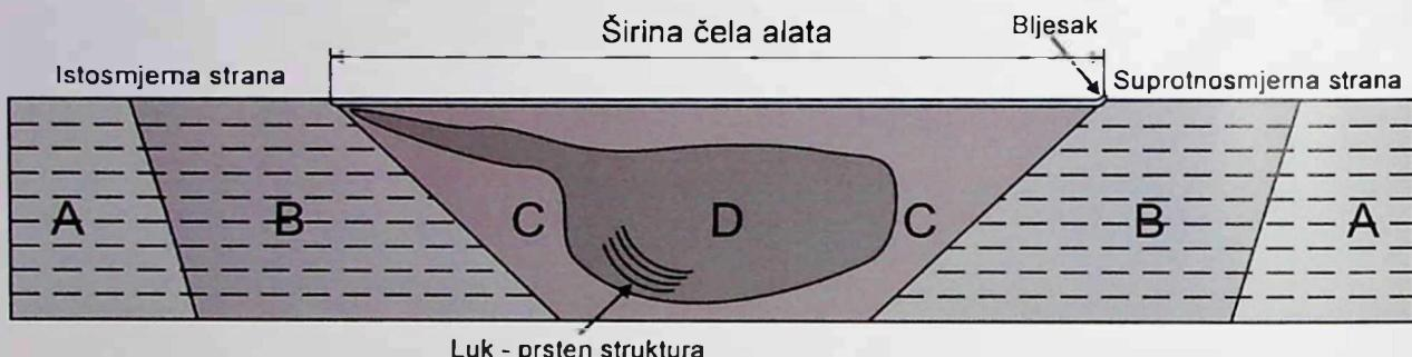
Slika 4.4. Struktura zavarenog spoja kod procesa FSW
