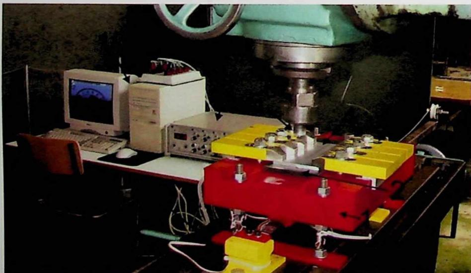
Slika 5.2. Istraživačko mjesto: 1 - osnovna ploča, 2 - oslona ploča, 3 - stezač, 4 - radni komadi od legure 6082-T6, 5 - alat za FSW, 6 - stezna glava glodalice, 7 - specijalni nosač sa nalijepljenim mjerim trakama, 8 - mjeri most, 9 - BAS, 10 - PC računar sa A/D karticom i programom GLOBAL LAB, 11 - radni sto glodalice
