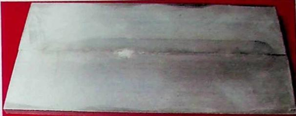
Slika P.1.50. Prikaz zavarenog spoja u 25. tački eksperimentalnog plana (pogled odozdo)
