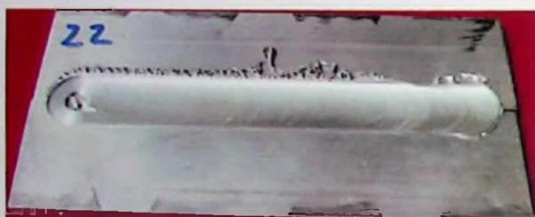
Slika P.1.43. Prikaz zavarenog spoja u 22. tački eksperimentalnog plana (pogled odozgo)
