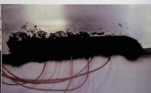
Slika 6.12. Lijepljenje termo-parova dvokomponentnim ljepilom
