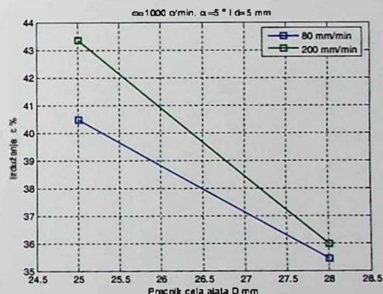
Slika 8.47. Dijagram procentualnog izduženja u funkciji prečnika čela alata za  $1000 \text{ o/min}$
