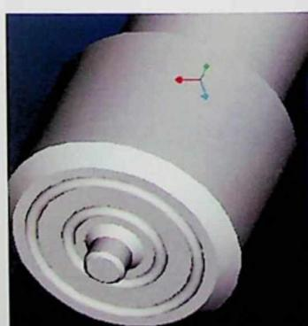
Slika 8.95. Profilisano čelo alata
