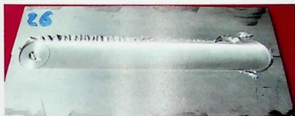
Slika P.1.51. Prikaz zavarenog spoja u 26. tački eksperimentalnog plana (pogled odozgo)
