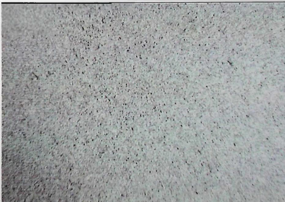
Slika 6.60. Mikrostruktura „grumen“ zone, uvećanje 100 x
