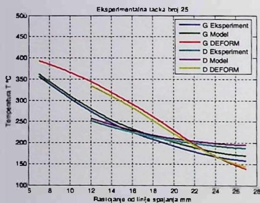
Slika P.6.21. Temperatura u 25. tački eksperimentalnog plana
