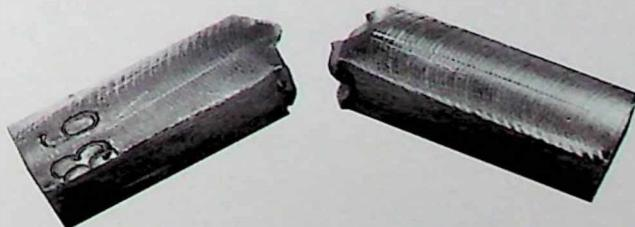
Slika 6.44. Ispitana epruveta u centralnoj tački eksperimentalnog plana broj 36
