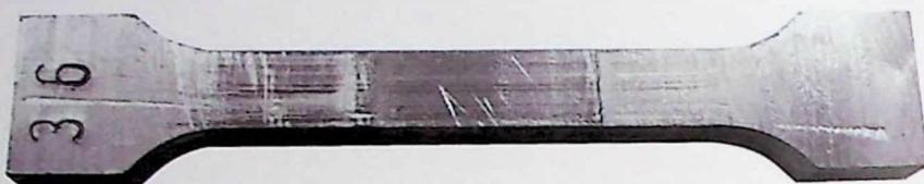
Slika 6.32. Uzorak (epruveta),  $y$  - pravac normalan na pravac zavarivanja
