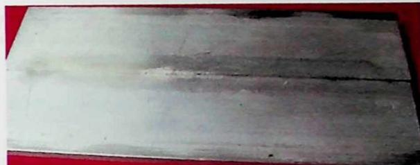
Slika P.1.52. Prikaz zavarenog spoja u 26. tački eksperimentalnog plana (pogled odozdo)
