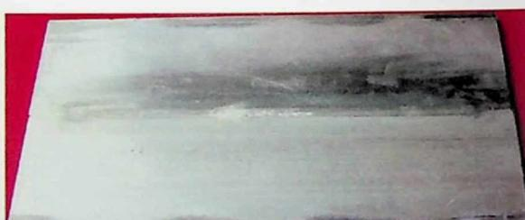
Slika P.1.46. Prikaz zavarenog spoja u 23. tački eksperimentalnog plana (pogled odozdo)
