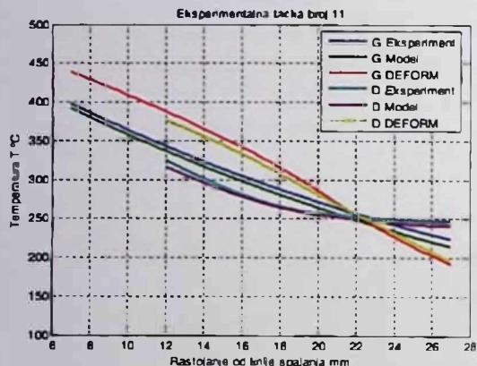
**Slika P.6.9. Temperatura u 11. tački eksperimentalnog plana**
