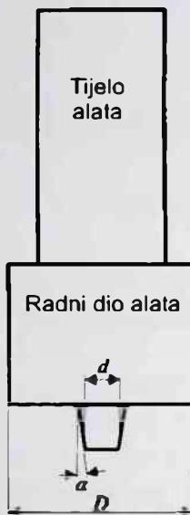
Slika 6.1. Familija alata za proces FSW:  $D$  - prečnik čela alata,
