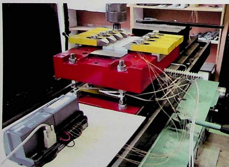
Slika 6.20. Prikaz mjerjenja temperature kod procesa FSW
