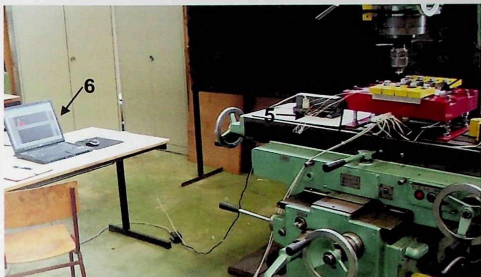
Slika 5.20. Prikaz istraživačkog mesta: 1 - stegnuti radni komadi, 2 - alat za FSW, 3 - mjerni moduli, 4 - prikačeni termo-parovi, 5 - osmokanalni ulazni modul, 6 - računar
