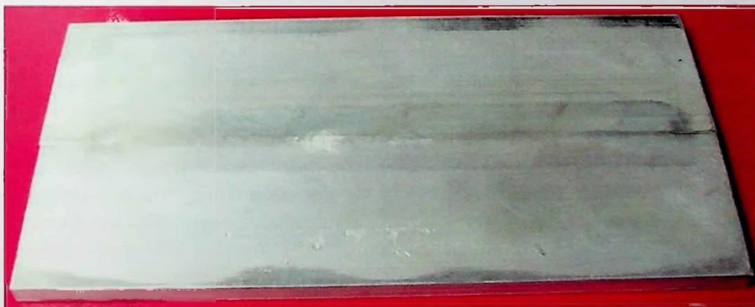
Slika 6.18. Izgled zavarenog spoja sa donje strane zavarenih radnih komada, u centralnoj tački plana broj 36
