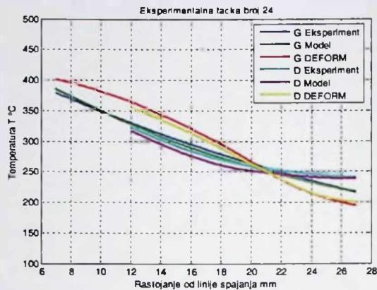
Slika P.6.20. Temperatura u 24. tački eksperimentalnog plana
