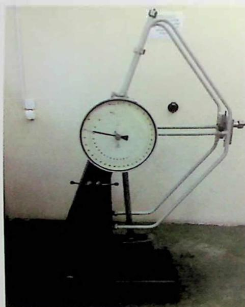
*Slika 6.41. Korišćeno Šarpijev klatno za ispitivanje udarne žilavosti*
