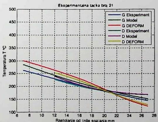
Slika P.6.17. Temperatura u 21. tački eksperimentalnog plana
