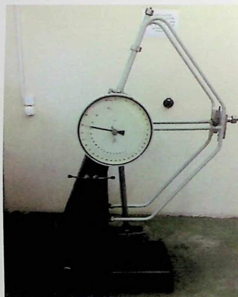
*Slika 6.41. Korišćeno Šarpijevo klatno za ispitivanje udarne žilavosti*
