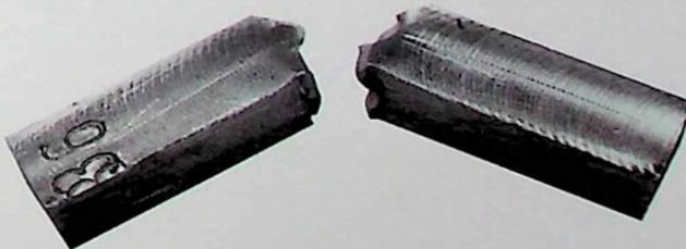
Slika 6.44. Ispitana epruveta u centralnoj tački eksperimentalnog plana broj 36
