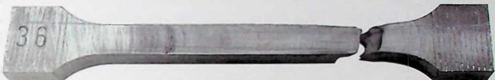
Slika 6.35. Isteognuta epruveta, isječena iz x - pravca, za centralnu tačku eksperimentalnog plana broj 36
