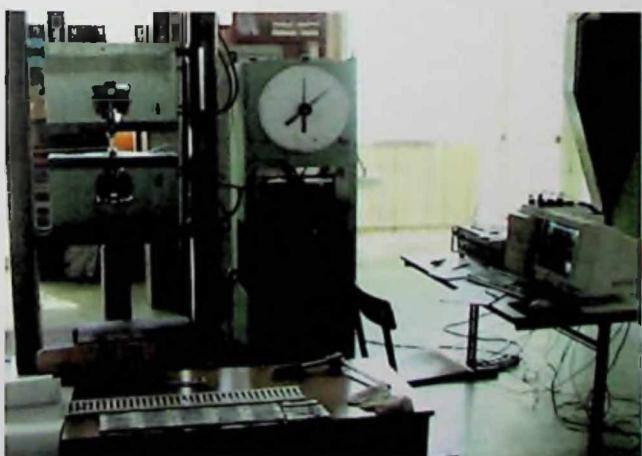
Slika 6.37. Ispitivanje epruveta zatezanjem
