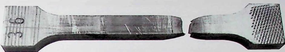
Slika 6.34. Isteognuta epruveta, isječena iz y - pravca, za centralnu tačku eksperimentalnog plana broj 36
