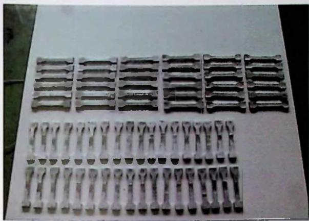
Slika P.7.11. Pripremljene epruvete za ispitivanje istezanjem
