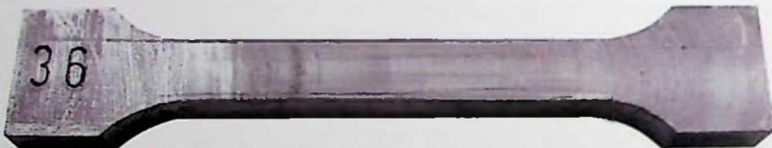
Slika 6.33. Uzorak (epruveta),  $x$  - pravac koji se poklapa sa pravcem zavarivanja
