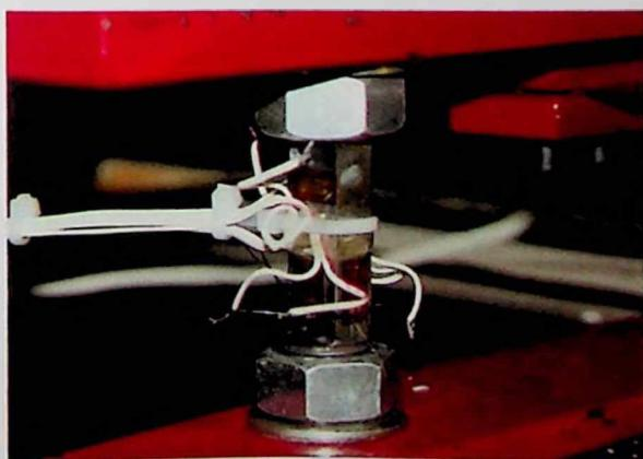
Slika 5.16. Specijalni nosač sa nalijepljenim mjerim trakama
