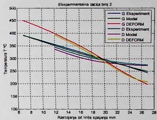
Slika P.6.2. Temperatura u 2. tački eksperimentalnog plana
