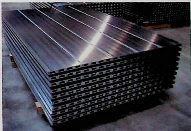
Slika 4.14. Proizvodnja poda željezničkih vagona korišćenjem postupka FSW [191]
