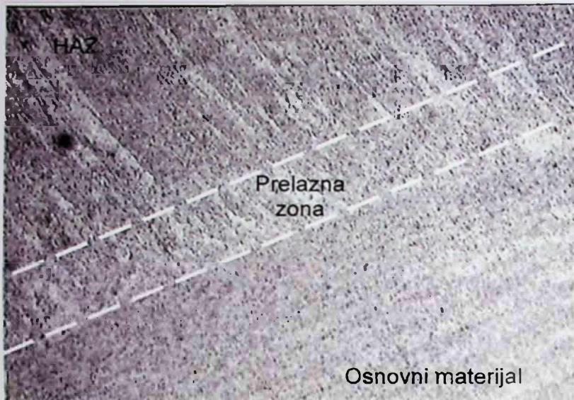
Slika 8.57. Mikrostruktura HAZ - OM uzorka broj 17
