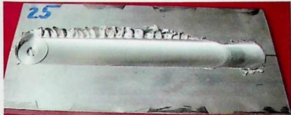
Slika P.1.49. Prikaz zavarenog spoja u 25. tački eksperimentalnog plana (pogled odozgo)
