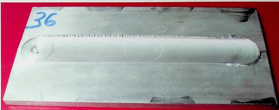
Slika 6.17. Izgled zavarenog spoja sa gornje strane zavarenih radnih komada, u centralnoj tački plana broj 36
