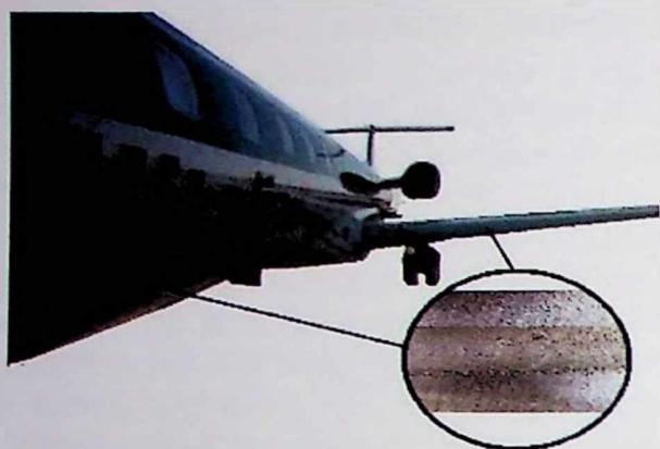
Slika 4.15. Zavarivanje trupa aviona konačenjem postupka FSW [191]
