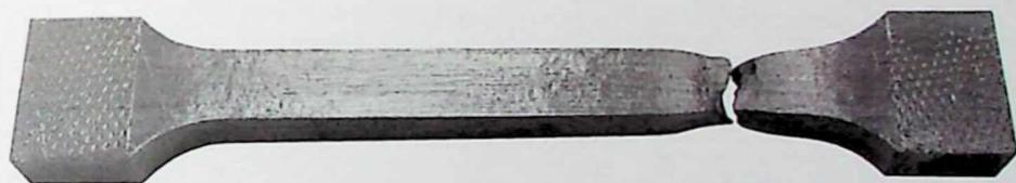
Slika 6.36. Isteognuta epruveta osnovnog materijala broj 4
