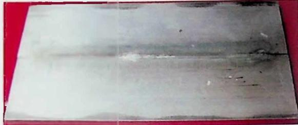
Slika P.1.42. Prikaz zavarenog spoja u 21. tački eksperimentalnog plana (pogled odozdo)
