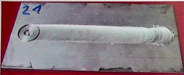
Slika P.1.41. Prikaz zavarenog spoja u 21. tački eksperimentalnog plana (pogled odozgo)
