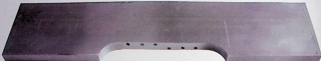
Slika 6.9. Izbušene rupe u radnom komadu, sa napravljenim upustom
