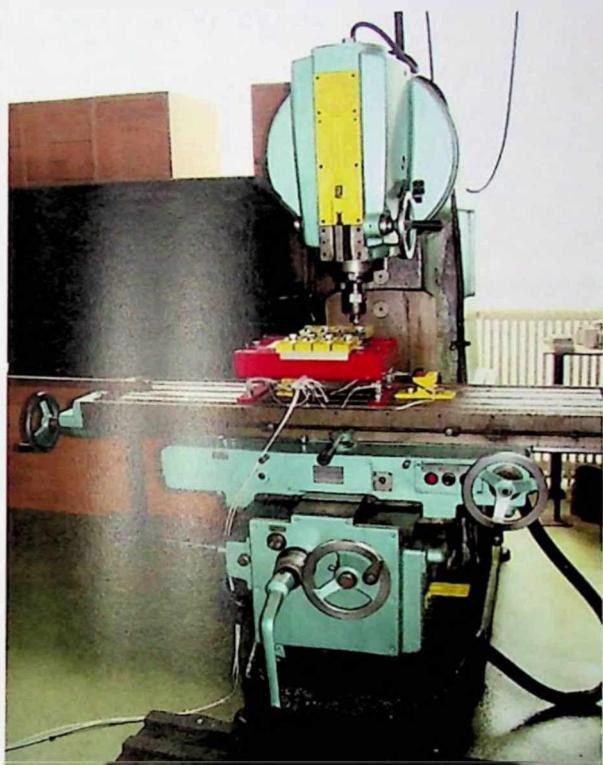
Slika P.7.1. Horizontalna glodalica,
