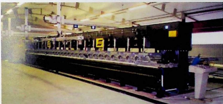
Slika 4.17. Mašina za zavarivanje postupkom FSW,
