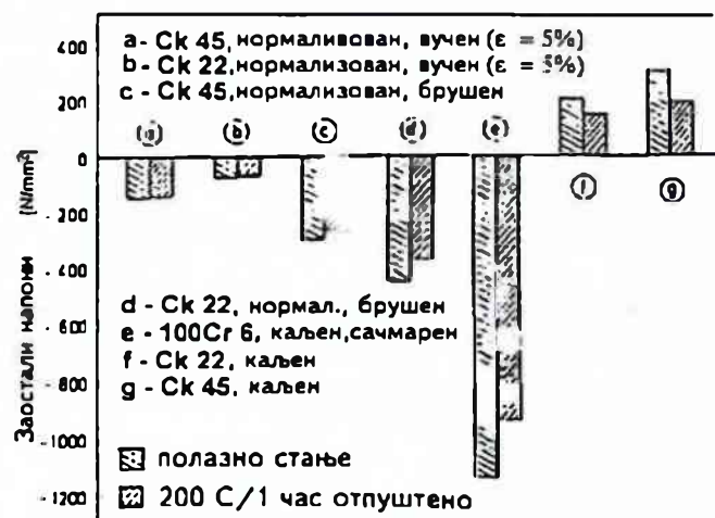
Слика 2.20 - Уклањање ЗН једносатним отпуштањем код различитих врста челика
