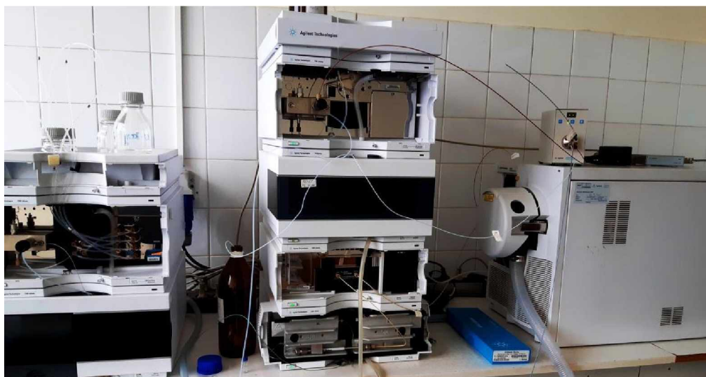
Slika 3.4. Uređaj za LC-DAD-MS analizu - Agilent LC/MS System 1260/6130
