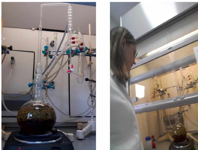
Slika 3.2. Izolacija etarskog ulja iz biljnog materijala postupkom hidrodestilacije u aparaturi po Klevendžeru
