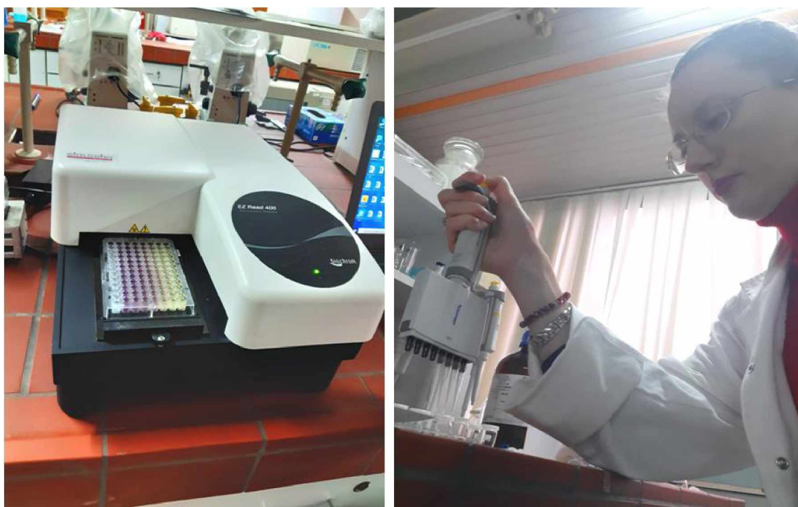
Slika 3.6. Fotografije tokom izvođenja DPPH testa i rada na uređaju Biochrom EZ Read 400
