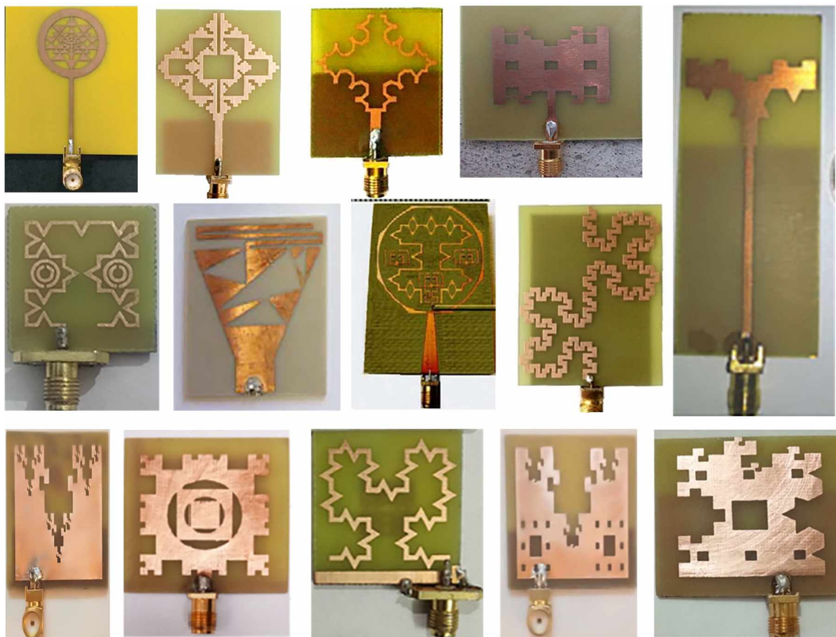
Slika 5.22: Primjeri hibridnih fraktalnih antena iz preglednog rada [54] 2
