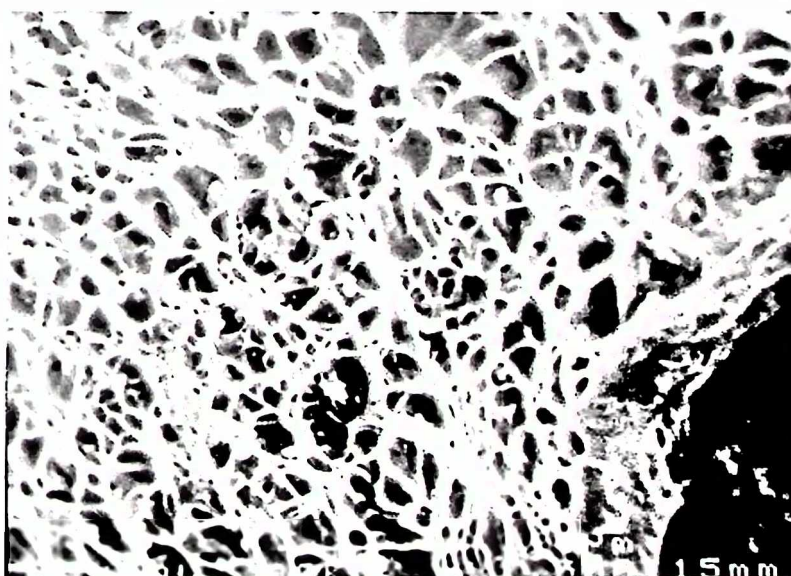
Slika 3.55 Mehanizam po kojem se odvija duktilni lom kod ADI (legura L1 austenitizovana na 900°C, 120 minuta i izotermno poboljšavana na 400°C, 240 minuta)
