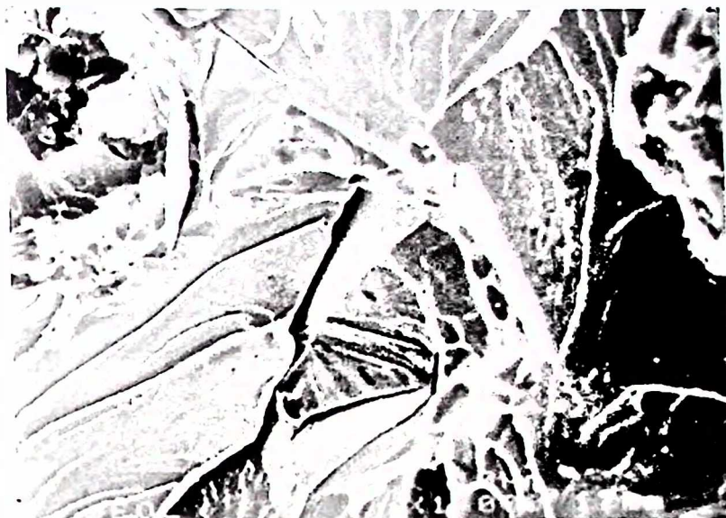
Slika 3.60 Mehanizam po kojem se odvija krti lom kod ADI (legura L2 austenitizovana na 900°C/120 minuta i izotermno poboljšavana na 300°C/1 minut)
