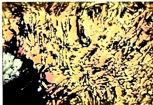
Slika 3.15 Mikrofotografije strukture legure L4 nakon austenitizacije od 120 minuta na temperaturi 900°C i izoternog poboljšavanja od 120 minuta na temperaturama a) 300°C; b) 350°C i c) 400°C (termički bojeno stanje)
