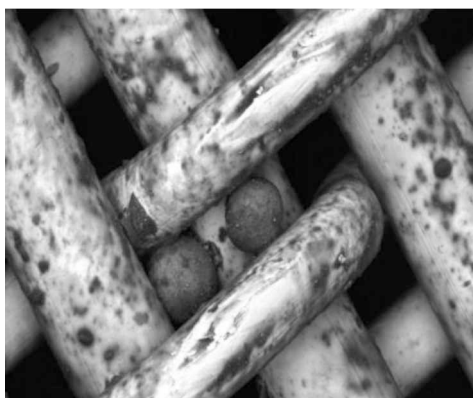
Slika 66. Mikroskopska slika katalitičkih nečistoća zarobljenih u mrežici filtera goriva
