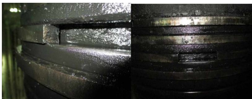
Slika 39. Oštećenja klipnog prstena kod motora u eksploataciji
