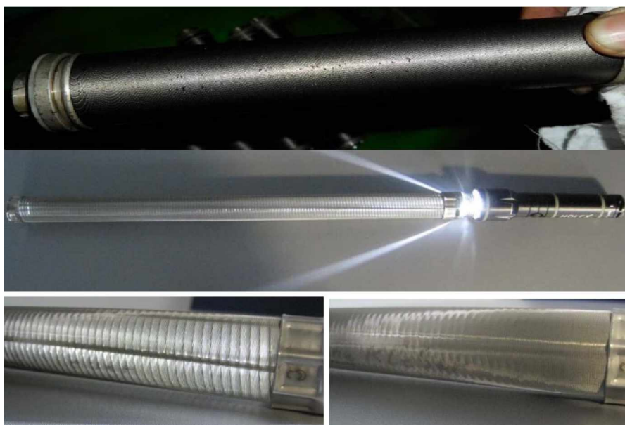
Slika 71. Primjeri zaprljanog filtera, te provjere djelimično i očišćenog filtera
