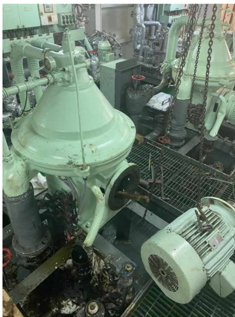
Slika 22. Separator prilikom održavanja
