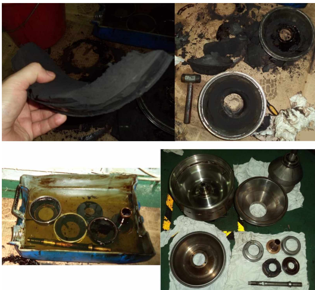
Slika 70. Akumulirane nečistoće na separatoru goriva i očišćeni dijelovi separatora
