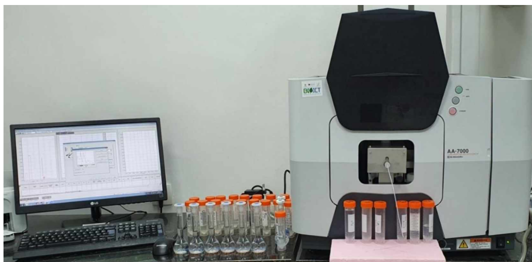
Slika 4.12 Atomski apsorpcioni spektrofotometar, Shimadzu AA 7000 (F–AAS)
