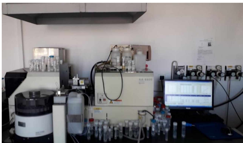
Slika 4.15 Atomski apsorpcioni spektrometar, Shimadzu AA 6800 sa grafitnom tehnikom
