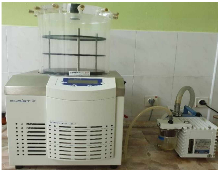
Slika 4.8 Liofilizator (CHRIST, Alpha 2–4 LD plus, Njemačka)
