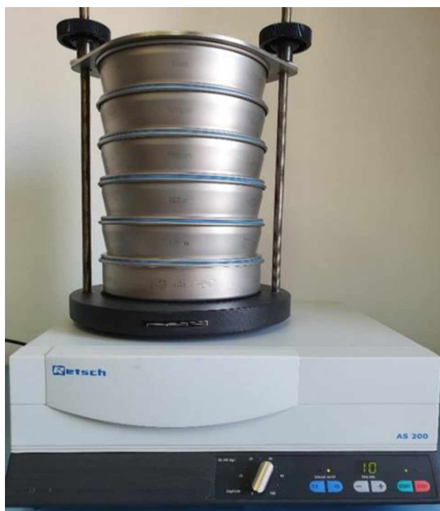
Slika 4.9 Set sita za prosijavanje uzoraka – Vibraciona tresilica (Retsch, AS 200 digit)
