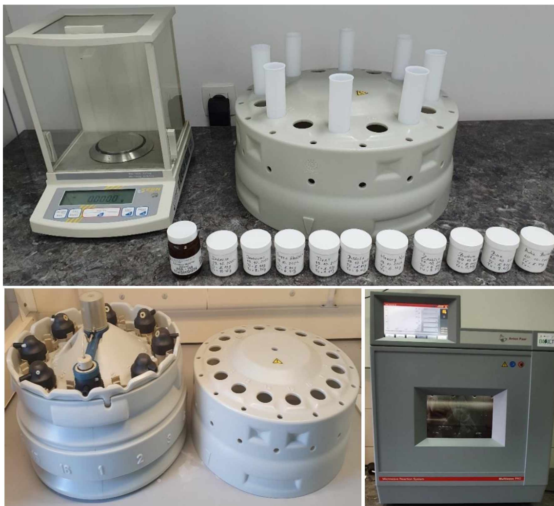
Slika 4.10 Postupak pripreme uzoraka za mikrotalasnu razgradnju i mikrotalasna pećnica Anton Paar, Multiwave PRO
