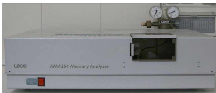
Slika 4.16 Direktni Hg analizator (Advanced Mercury Analyzer AMA 254, Altec, Leco)
