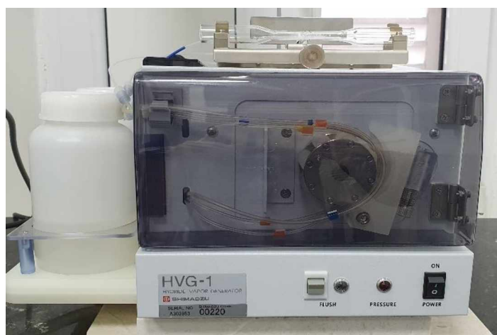
Slika 4.13 Generator pare HVG–1, Shimadzu AA7000
