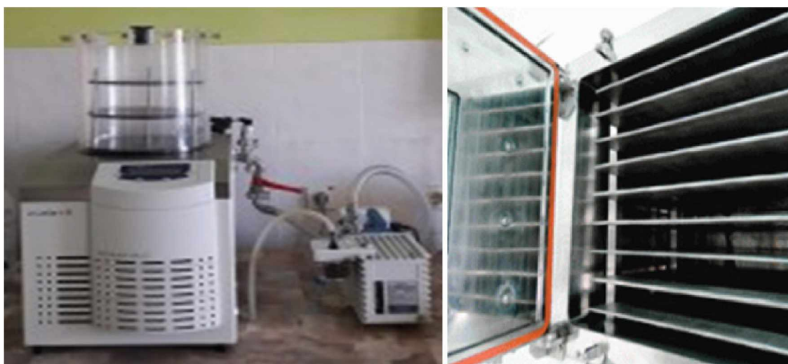
Fotografija 3: Liofilizator ALPHA za liofilizaciju uzoraka riba (foto:iz sopstvene kolekcije)
