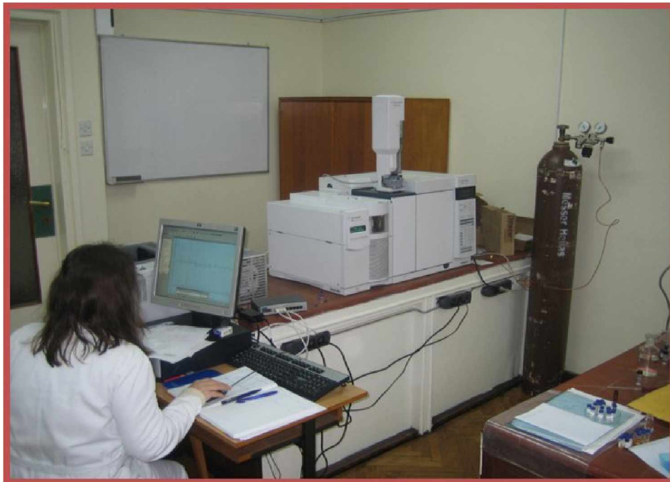
Fotografija 2: 5 Agilent 7890N uz maseno spektrometrijski detektor Agilent 5975 (foto: iz sopstvene kolekcije)
