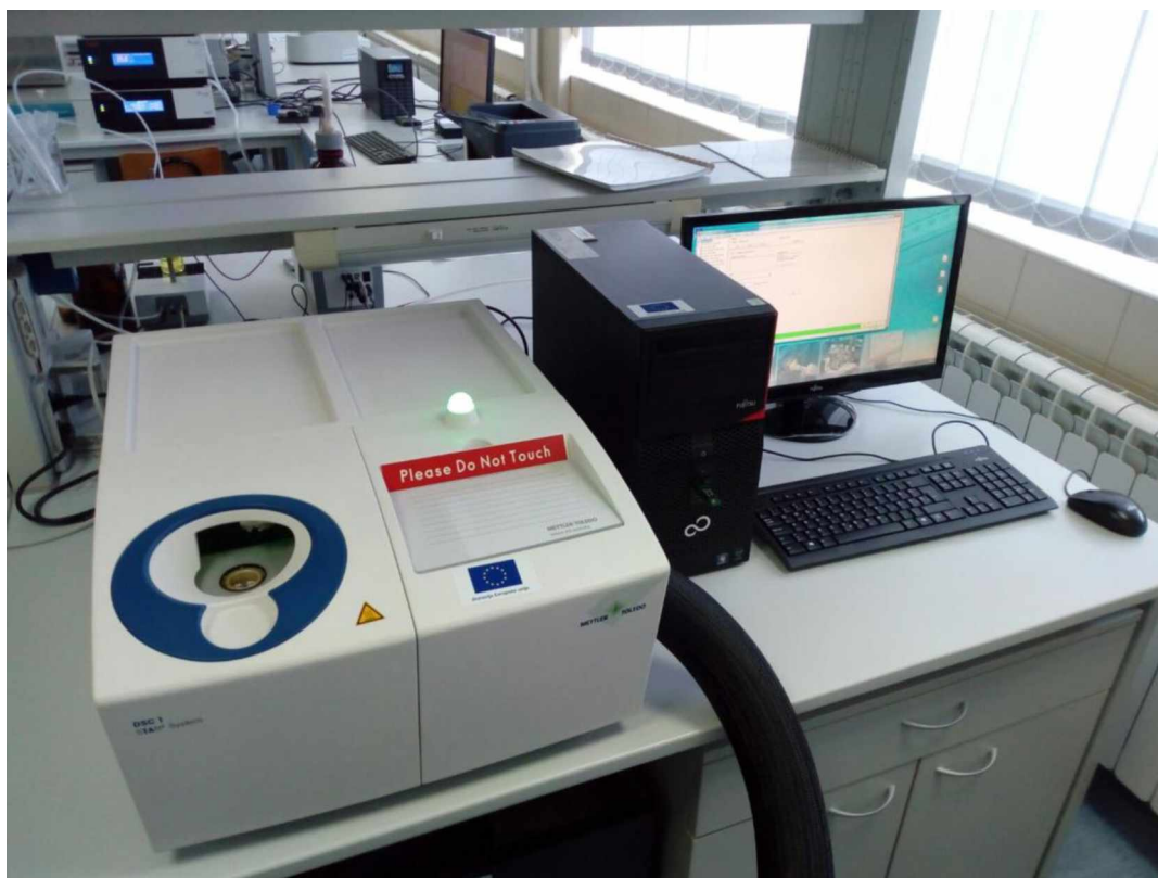
Slika 33. DSC1 (Mettler Toledo, Njemačka) uređaj na kome je vršena DSC analiza izrađenih DLP tableta
