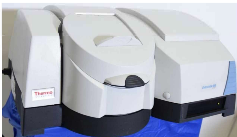
Slika 23. Uređaj Evolution 300 (Thermo Fisher Scientific, Velika Britanija) pomoću koga je spektrofotometrijski određen sadržaj atomoksetina u DLP izrađenim tabletama
