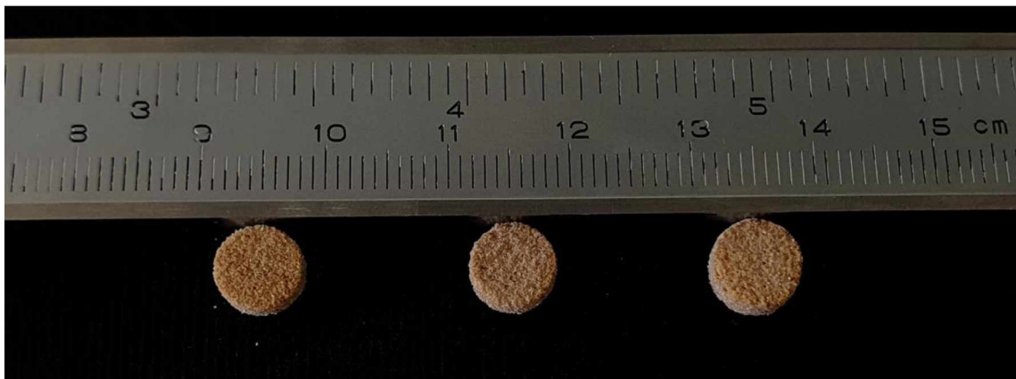
Slika 54. Izrađene SLS tablete atomoksetina dimenzija 8\text{mm} \times 3\text{mm}
