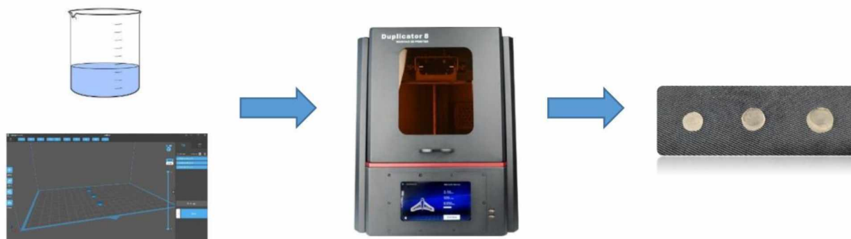
Slika 34. Shematski prikaz procesa štampanja DLP tehnikom i dobijene tablete debljine 1 mm, 2 mm i 3 mm
