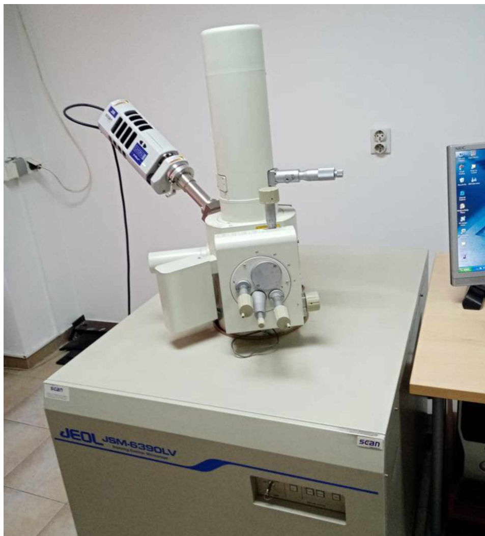
Slika 51. JEOL JSM-6390LV uređaj na kome je vršena SEM analiza
