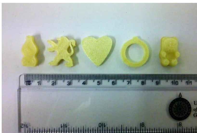
Slika 3. Tablete za žvakanje u obliku Starmix ® Haribo gumenih bombona sa indometacinom, izrađene FDM tehnikom (preuzeto iz Scoutaris i sar., 2018 (29))
