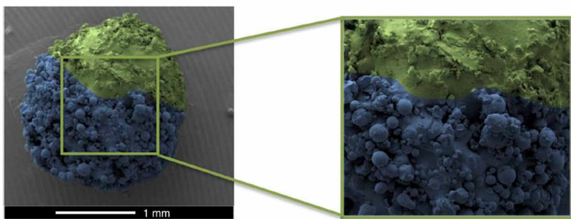
Slika 19. SEM slika mini tableta konfiguracije B, gdje zeleni region predstavlja region u kom se nalaze paracetamol i etil celuloza, dok se u plavom regionu nalaze ibuprofen i Kollicoat® IR (preuzeto iz Awad i sar., 2019 (114))
