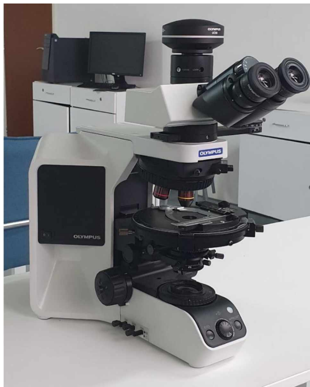
Slika 24. Polarizacioni mikroskop (Olympus BX 51P, Olympus, Japan) pod kojim je posmatran poprečni presjek DLP izrađenih tableta, prije i posle ispitivanja brzine oslobađanja atomoksetina
