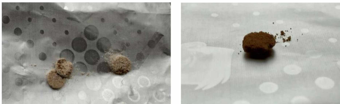
Slika 53. Primjeri neuspješnih pokušaja štampanja tableta SLS 3D tehnikom
