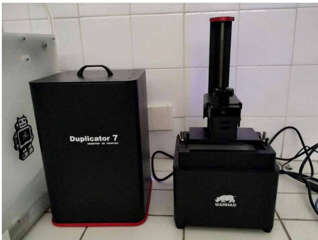
Slika 22. Wanhao Duplicator 7 3D štampač koji je korišten za štampanje tableta u prvoj fazi eksperimentalnog rada
