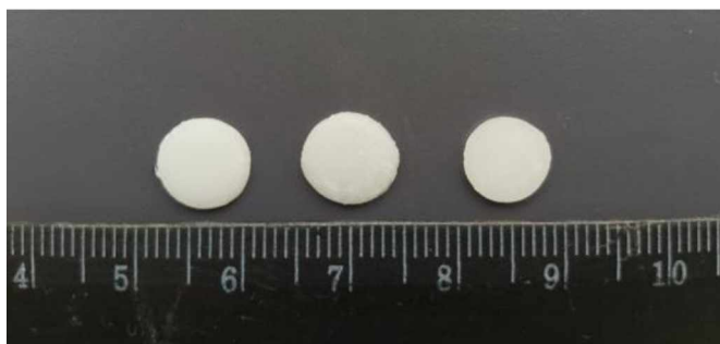
Slika 35. DLP izrađene tablete sa 15% atomoksetina, prečnika 8 mm i debljine 2 mm
