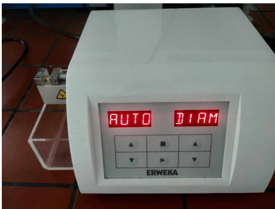
Slika 49. Određivanje čvrstine izrađenih SLS tableta na Erweka TBH 125D uređaju
