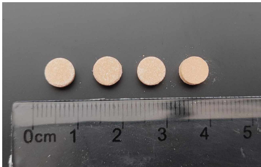
Slika 56. Tablete izrađene pomoću simulatora kompakcije iz iste fizičke smješe iz koje su štampane tablete SLS tehnikom
