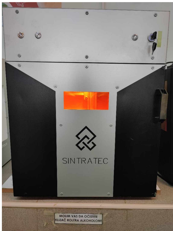
Slika 47. Sintratec Kit (Sintratec, Švajcarska) 3D štampač pomoću kod su izrađene SLS 3D štampane tablete atomoksetina
