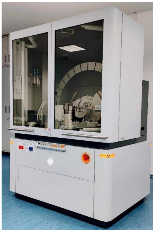
Slika 52. Empyrean, Malvern Panalytical difraktometar na kome je urađena XRPD analiza SLS tableta
