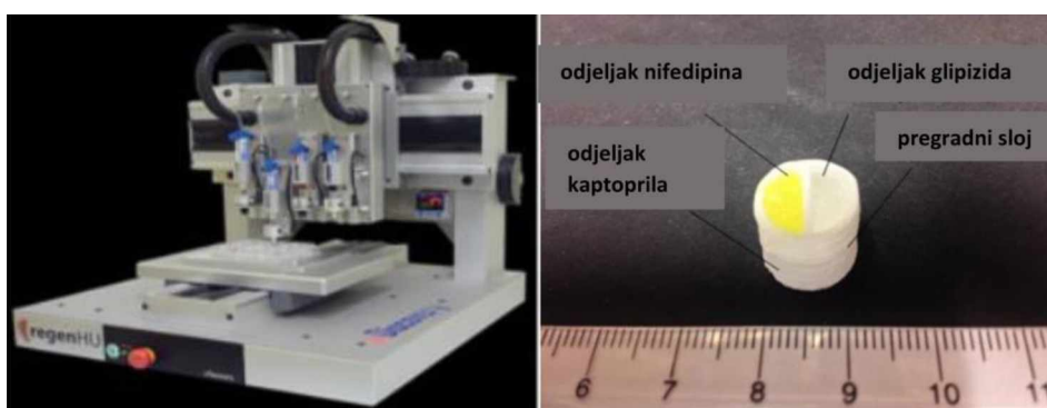
Slika 10. Prikaz RegenHU 3D štampača i višekomponentnih tableta (preuzeto i prilagođeno iz Khaled i sar., 2015 (33))
