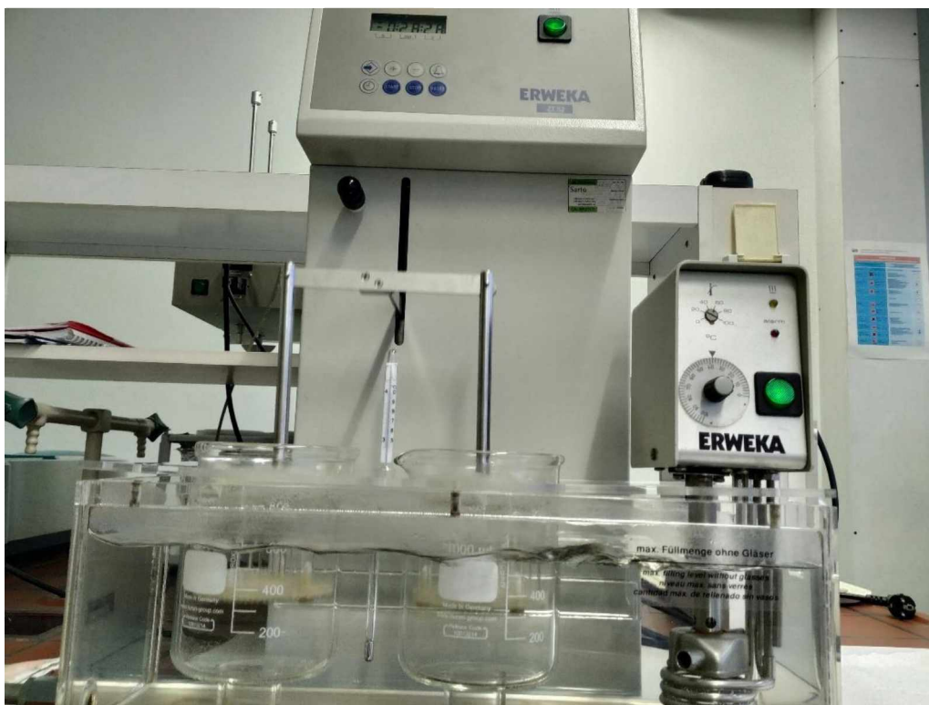
Slika 53. Ispitivanje raspadljivosti tableta na Erweka ZT 52 (Erweka, Njemačka) uređaju
