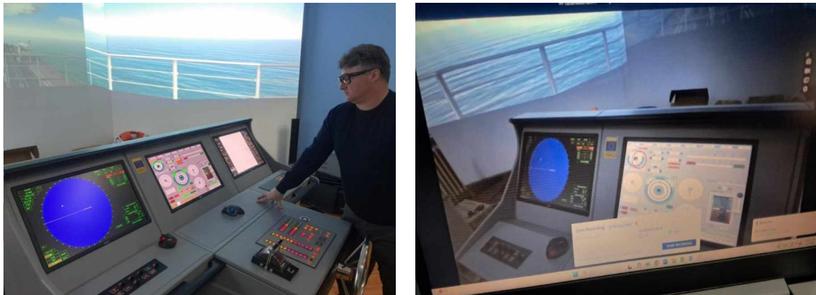
Slika 4-5 Primjena tehničkih alata - a) korišćenje Tobii naočara u simulatoru b) prikaz videa sa Tobii naočara na odgovarajućoj aplikaciji
