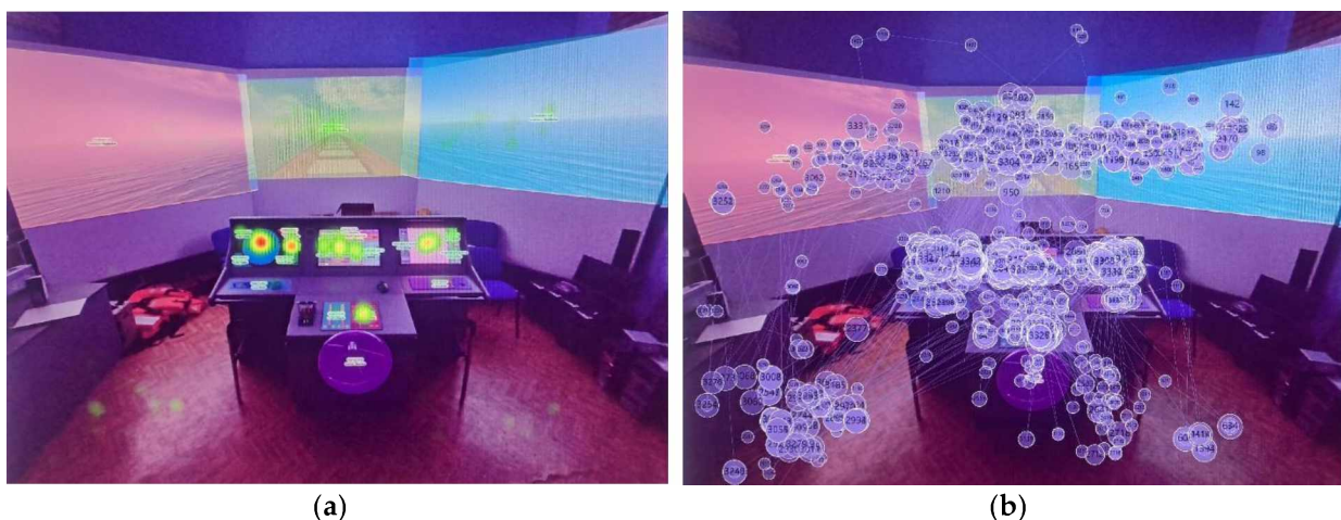
(a) (b) Slika 4-7 Vizuelni prikaz analize a) mapa inteziteta pogleda b) mapa pokreta oka
