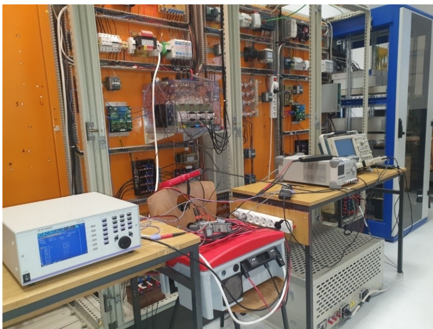
Slika 7.1 Laboratorijska postavka za snimanje harmonijskog spektra struje PV invertora
