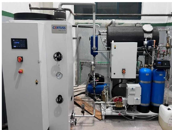
Slika 9. Certuss aparat koji je korišćen za parnu destilaciju etarskog ulja smilja
